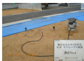
弊社モデルハウス建築前の地盤調査の様子
