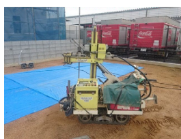
弊社モデルハウス建築前の地盤調査の様子
